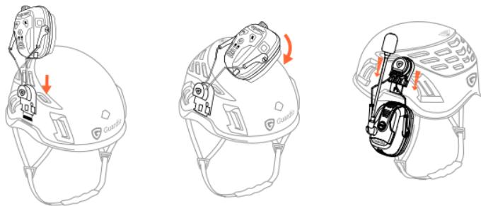
Press hjelmfestet innover mot hodet til hørselsvernet sitter tett rundt ørene. Pass på å justere plasseringen av øreklokkene slik at de dekker ørene helt for å unngå støylekkasje.
