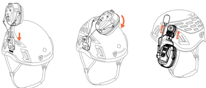
Pressa hjälmfästet inåt mot huvudet tills hörselskydden sitter tätt runt öronen. Se till att justera kåpans position så att de täcker dina öron helt för att undvika läckage av buller.
